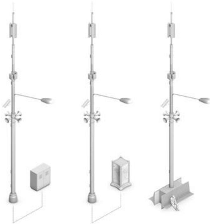
**Размещение части оборудования вне многофункциональной опоры
