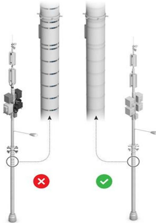
**Симметричное размещение оборудования на многофункциональной опоре**
