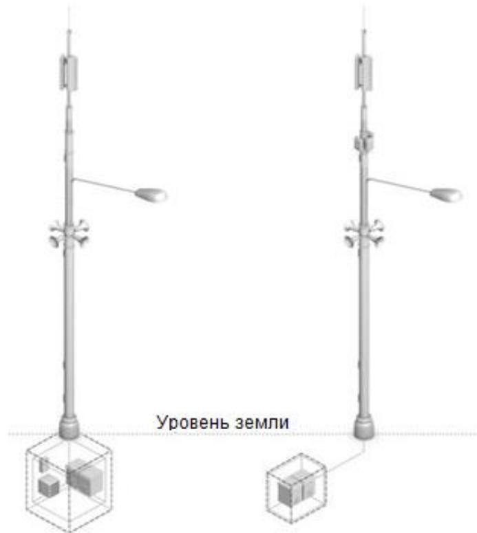
**Размещение части оборудования вне многофункциональной опоры на улице
